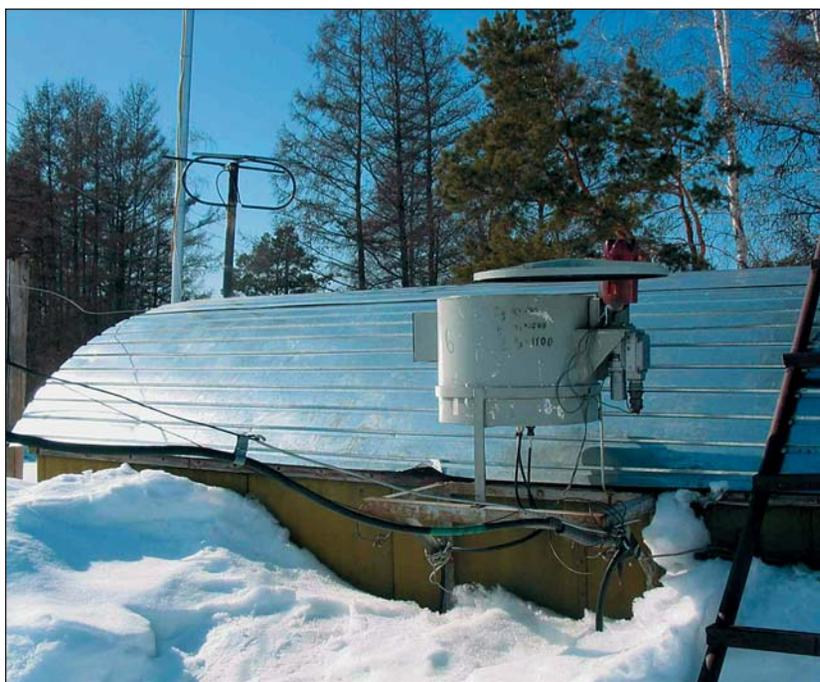
Рис.2. Станция наземного наблюдения с установленным на ней детектором черенковского излучения.
