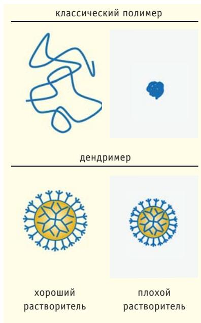
Рис.5. Объемные соотношения клубка и глобулы классического полимера и дендримера в растворителях разного качества.
