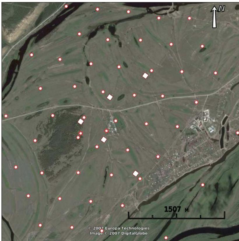
Рис.1. Расположение детекторов Якутской установки ШАЛ на спутниковом снимке. Сейчас работают 59 наземных станций (○) и шесть подземных детекторов мюонов (◇), включая большой мюонный детектор (площадью 180 м<sup>2</sup>, на схеме не показан).
